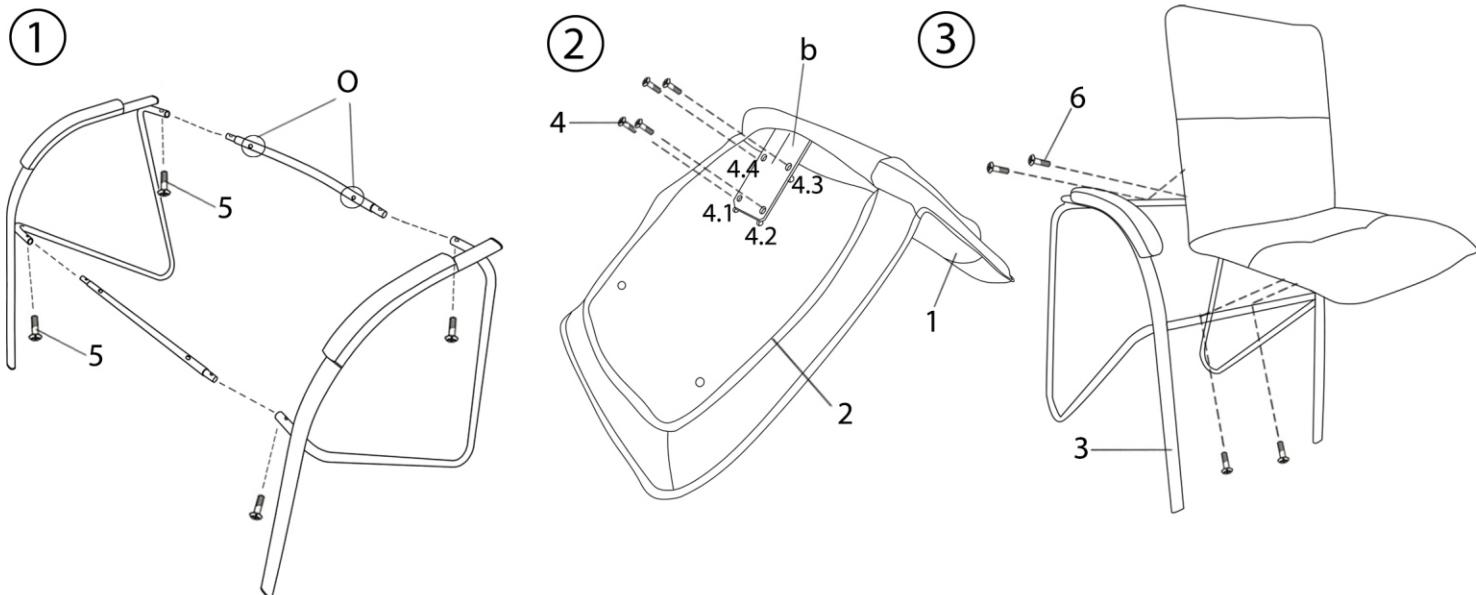
**1.** Вставьте перемычки в боковины каркаса и зафиксируйте их винтами (5), согласно схемы 1, при помощи шестигранного ключа.
