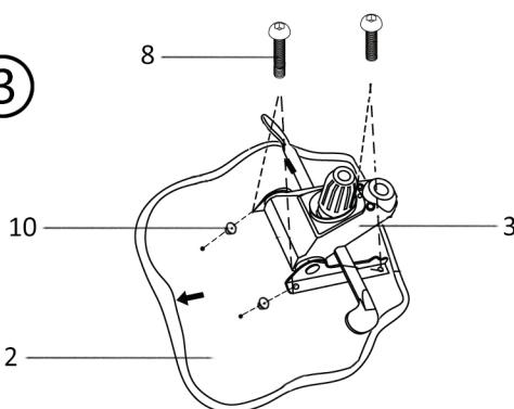
3. Приложите механизм качания (3) к сидению кресла (2), подложите под переднюю часть механизма пластиковые шайбы (10). Закрепите механизм винтами (8).
