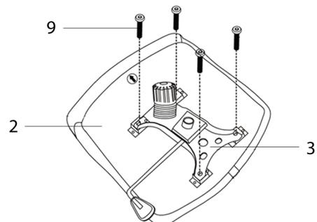
4. Приложите механизм качания (3) к сидению (2) таким образом, чтобы стрелка на механизме была направлена к передней стороне кресла. Закрепите механизм винтами (9).
